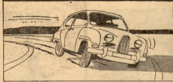
SAAB är liksom DKW kraftigt understyrd och släpper med framhjulen först. Släpps gasen i kurvan minskas understyrningen.
